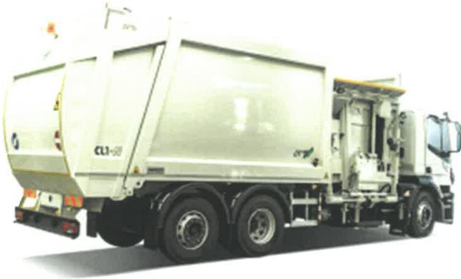
I servizi sui nuovi cassonetti monoperatore saranno erogati con l'utilizzo di mezzi a caricamento laterale, adatti ad essere utilizzati da un solo operatore, con conseguente ottimizzazione di risorse. Si riporta di seguito un estratto dalla scheda tecnica del mezzo AMS CL1-N.
